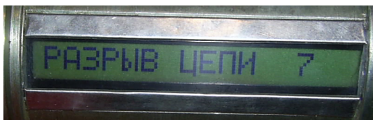
рис. 3 Сообщение в случае нарушений цепи датчика в процессе измерения
