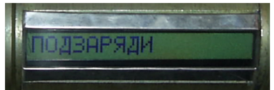
рис. 6 Индикация предупреждения о предразрядном состоянии аккумулятора
