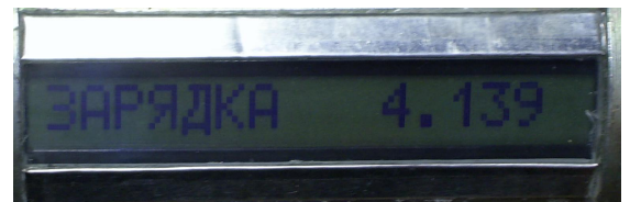
рис. 8 Сообщение в процессе зарядки, и текущее напряжение аккумулятора
