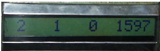
рис. 1 Индикация конечной температуры и отклонений промежуточных значений температуры сразу после измерения
