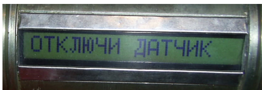
рис. 5 Заблокировано сообщение о результате измеренной температуры до снятия горячей термопары с арматуры погружной
