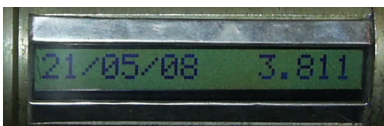
рис. 4 Индикация текущей даты и напряжения аккумулятора
