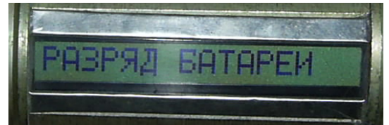
рис. 7 Индикация сообщения о полном разряде аккумулятора, прибор заблокирован
