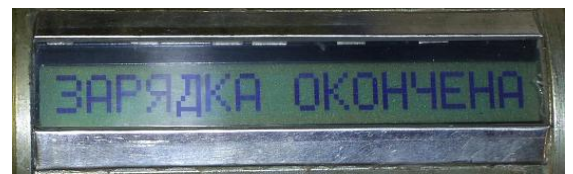
рис. 9 Сообщение после автоматического отключения зарядного тока
